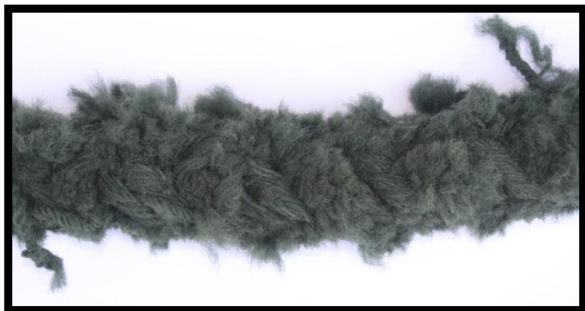
Zdjęcie 6: Nadmierne zużycie liny kwalifikujące do wycofania z użycia.
