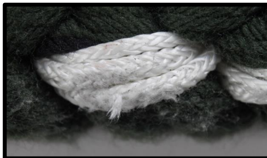
Zdjęcie 8: Wytarcie powierzchniowe zakończenia DLT.
