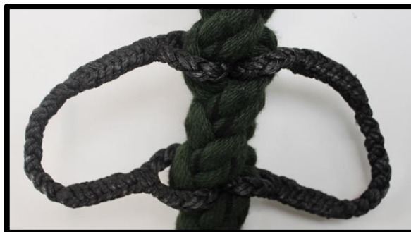
Zdjęcie 12: Para dwóch pętli systemu F.R.I.E.S.
