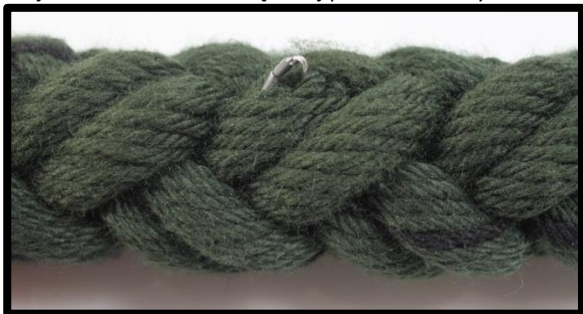
Zdjęcie 10: Wysunięcie linki z obciążnikami ze splotów liny
