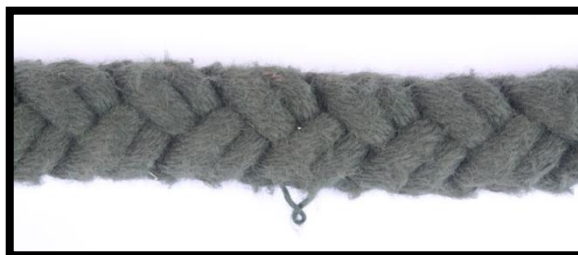
Zdjęcie 3: Zaciągnięte włókno o długości poniżej 25 mm.
