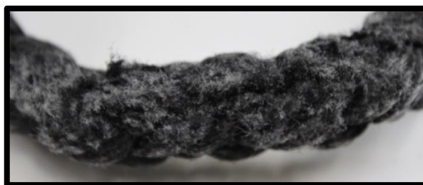
Zdjęcie 14: Poważne wytarcie pętli zaczepowej.
