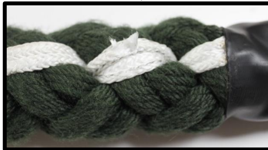
Zdjęcie 7: Przecięty splot pętli zakończenia DLT.
