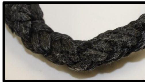
Zdjęcie 13: Normalne wytarcie pętli zaczepowej.
