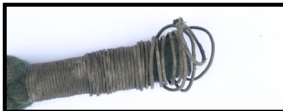
Zdjęcie 4: Brakujące lub uszkodzone zakończenie owijane musi zostać wymienione.
